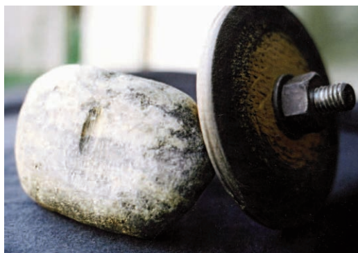
Fig. 2. Experiment med svarv: ekhjul mot sten av hård bergart ger räfflad skåra. Foto förf.
