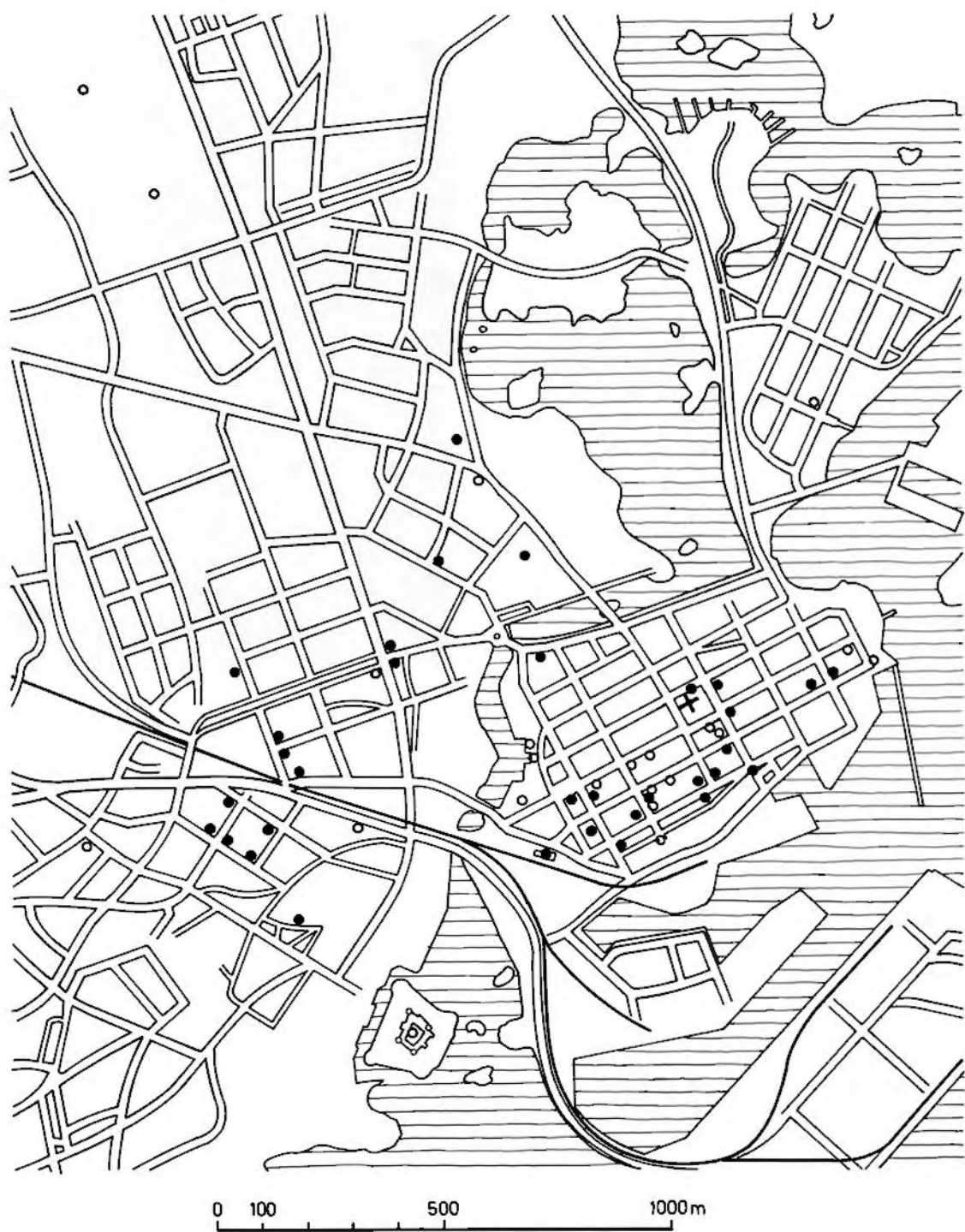
Figur 40. Kalmar. Byggnader med exteriört exponerad och bearbetad natursten markerade med cirklar. Fyllda cirklar avser byggnader med akuta skador.
