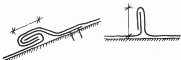
Falsbredden för hak- och ståndfals kan variera mellan 25–40 mm.
