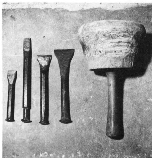
22. Stenhuggare Fride Nilssons verktyg: tre stycken släta bredmejslar, en tandad bredmejsel, träklubba. Foto G Hildebrand 1975
