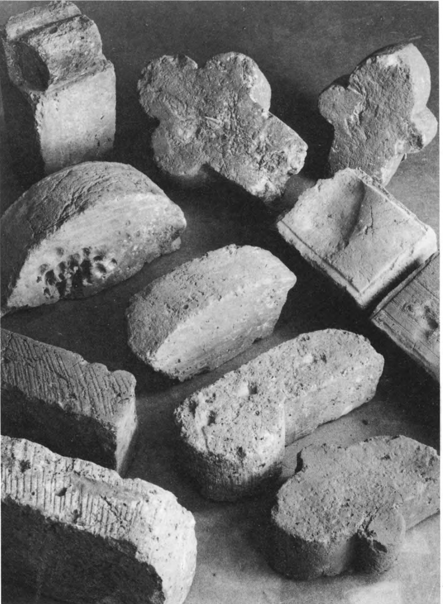
23. Urval av murtegel och formtegel. Tv nederst murtegel med räfflade godsidor. Th murtegel med spår från tegelslagning samt ribbtegel, konsol och formtegel till kolonner. 1200-tal. Vadstena gård och kloster, Östergötland. Foto I Anderson
