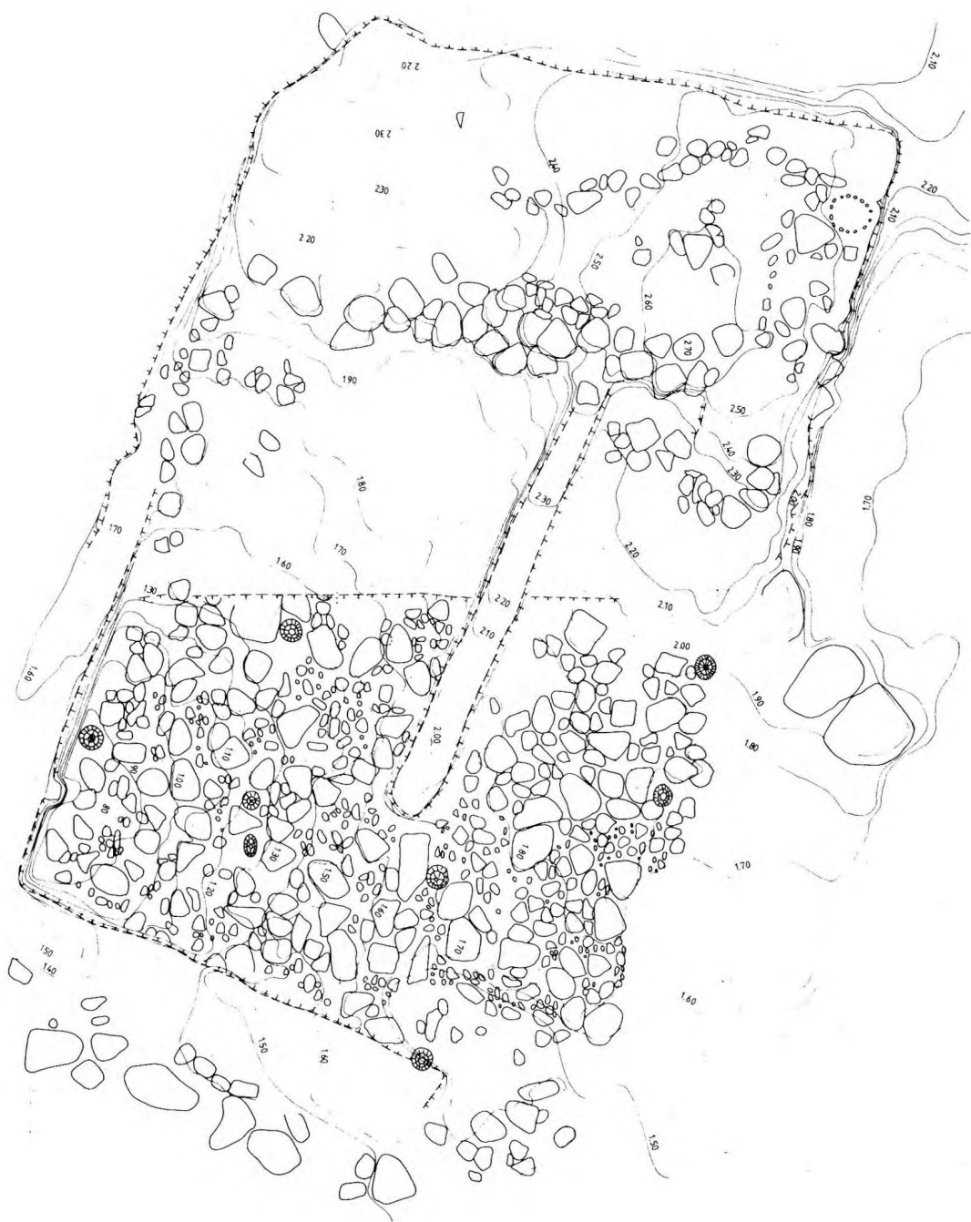
209. Uppmätning av utgrävningsområde på Helgeandsholmen, Stockholm. Originalskala 1:20. Fotogrammetrisk bearbetning av bilder tagna från skylift på ca 19 m höjd. Tid för fotografering inklusive kontrollmått, 1 tim. Tid för bearbetning i karteringsinstrument, 5 tim. G Redelius 1979
