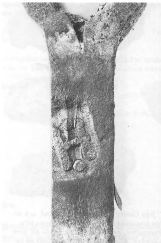
78. Ankarjärn med utsmidd ögla. Stämpeln svårdefinierad, många bergsmanshammare förde H-tecknet. Troligen levererat från Bergslagen. 1600-tal. Skokloster slott, Uppland. Foto Ulf Leijon 1974
