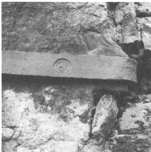
85. Detalj av föregående bild. Järnstämpel på stångjärnet från Strömsbergs bruk i Uppland. Stämpeln använd från 1737 och senare. Foto A Hildebrand 1972
