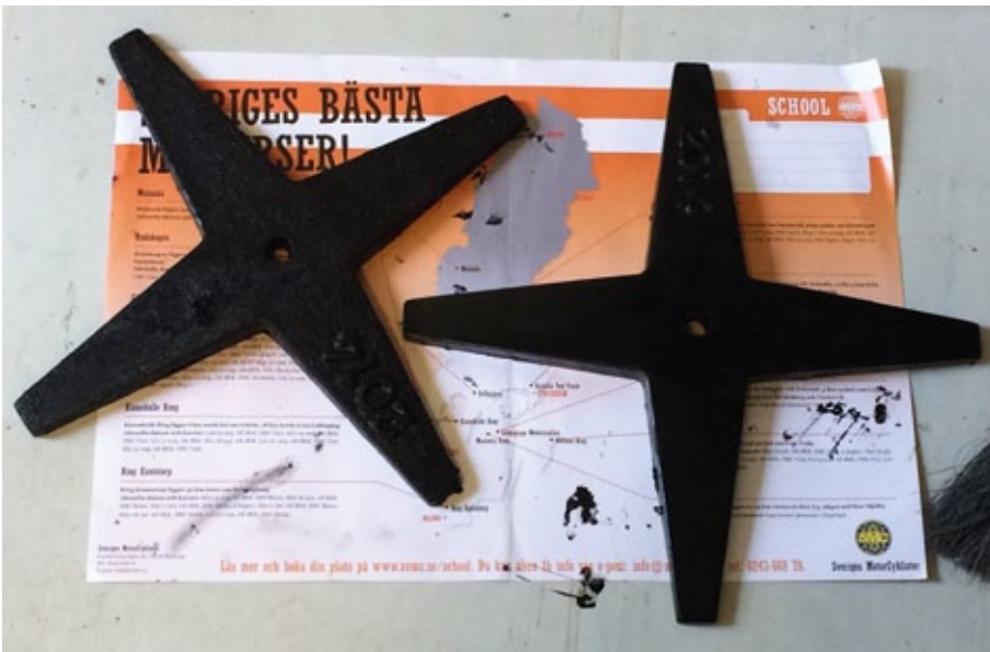
Figur 8.19. De synliga ankarjärnen före monteringen. Foto: Carl Thelin.
