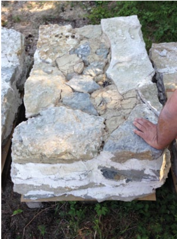
Figur 9.1. (ovan t.v.) Utprovning av murbruk för återuppbyggnaden av Visby ringmur. Foto: Kristin Balksten.
