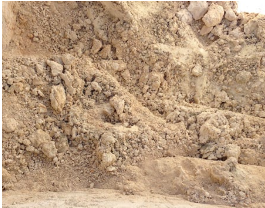
Figur 9.3. (t.h.) Jordsläckt kalk i markgrav som skall piskas innan det används till kalkbruk. Foto: Kristin Balksten.
