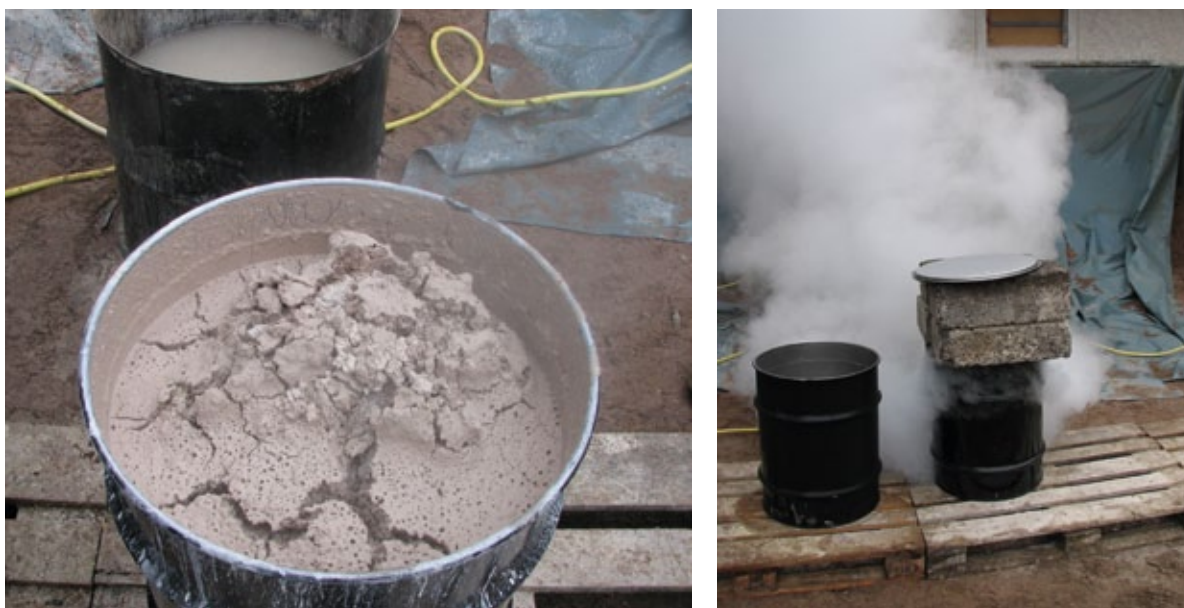
Figur 7.11. Vättsläckning under tryck har utvecklats för Kinnekullekalken. Foto: Kristin Balksten.
