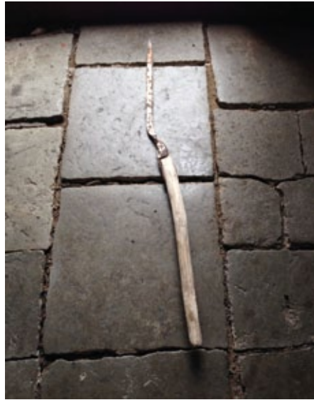
Figur 7.7. Till vänster ses en gammal kalkpiska från Svenneby gamla kyrka i Bohuslän. Till höger används en gammal gotländska kalkpiska i undervisningen vid kalkkurs i Väskinde. Foto: Kristin Balksten.
