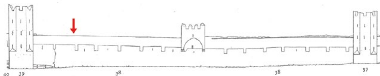
Figur 4.2. Exempel från Eckhofs planschverk (Eckhof 1922) som visar konturen av den första muren inritad på den nuvarande. Platsen för raset 2012 i mur 38 har markerats med den röda pilen. Notera också den vertikalt markerade sprickan där raset inträffade. Illustration: Carl Thelin efter Eckhoff.
