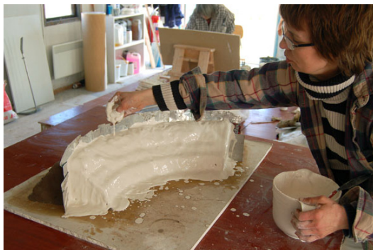
Fig. 20 Principskiss för formgjutning med gipskappa.
