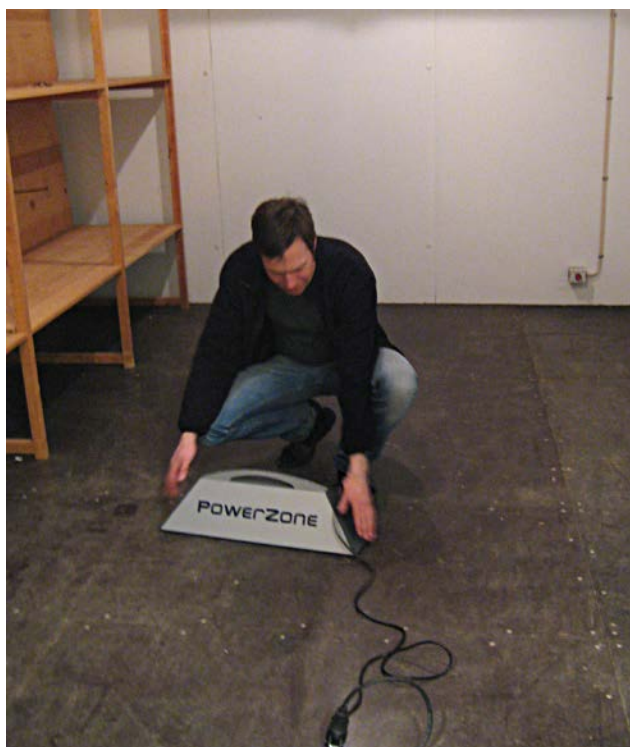
Ozonaggregat på Kulturmagasinet, Helsingborg. Aggregatet används endast i ett särskilt stängt rum. Foto: Margareta Bergstrand
