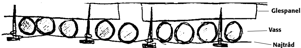
Fig. 3. Glespanel med putsbärande vass.
