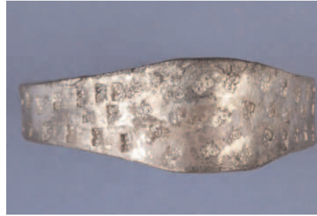
Armbygeln av silver har mörknat av svavel från luften. Dessutom finns lila silverklorid på ytan.
