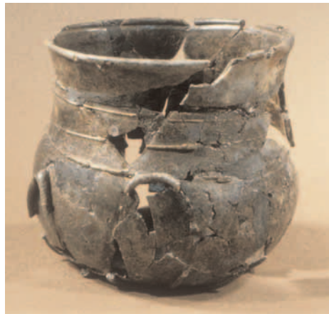
Glas som inte längre är glas. All alkali är urlakad, endast kisel och metallsalter återstår och föremålet är missfärgat och mycket sprött. Vikingatida gravfynd från Birka.
