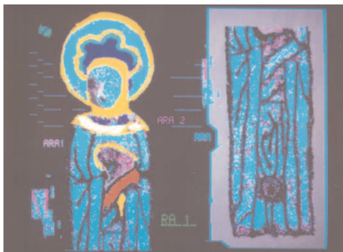
Kartläggning av grundämnen genom svepelektronmikroskopi och röntgenanalys.
