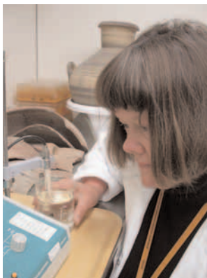
Med hjälp av konduktivitetsmätare kontrolleras salthalten i urlakningsvattnet.
