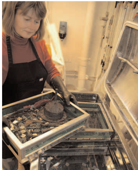
Järnföremålen stabiliseras genom att inneslutna salter lakas ur i avjoniserat vatten under kvävetillförsel i en speciellt utformad tank. Salterna bidrar annars till att föremålen fortsätter att rosta.
