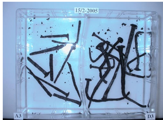
Spikar under urlakning i avjoniserat vatten med tillsats av natriumhydroxid, pH 12,5.
