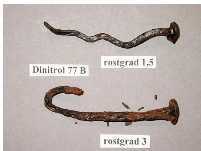
Exempel på spikar, efter korrosionsprovning, som rostskyddsbehandlats med Dinitrol 77B.
