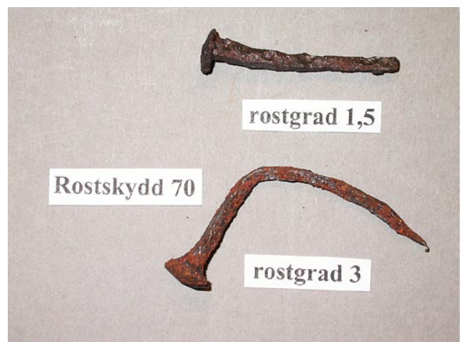
Exempel på spikar, efter korrosionsprovning, som rostskyddsbehandlats med Rostskydd 70.
