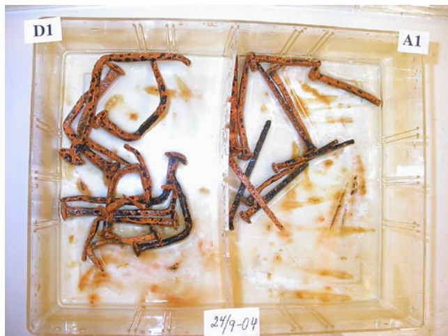
Spikar under urlakning i avjoniserat vatten.
