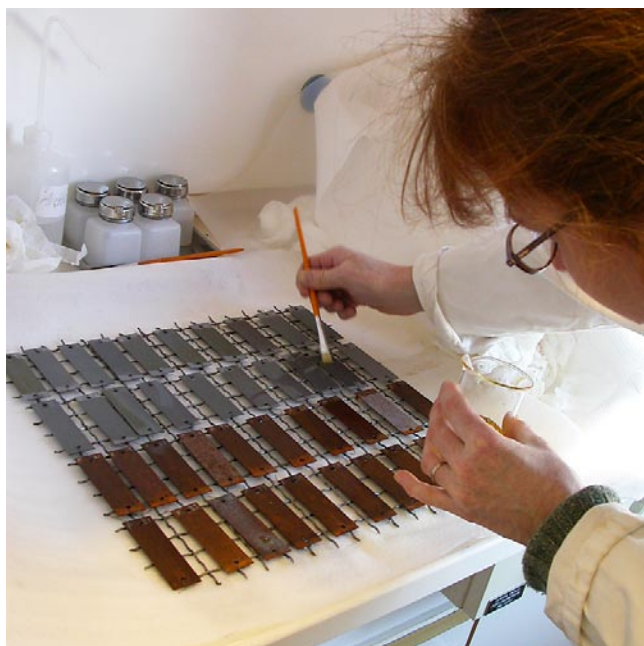
Applicering av rostskyddsmedel på provkupongerna.
