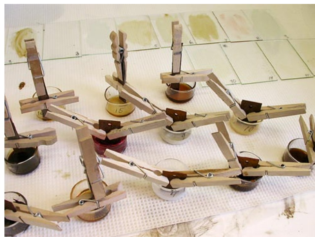
Test av rostskyddsmedlens uppsugningsförmåga mellan rostiga plåtar. I bakgrunden syns glasplåtar med utstryk av rostskyddsmedlen för test av ytfilm.
