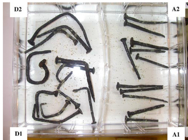
Spikar under urlakning med en buffertlösning av dinatriumvätefosfat och kaliumdivätefosfat i avjoniserat vatten.
