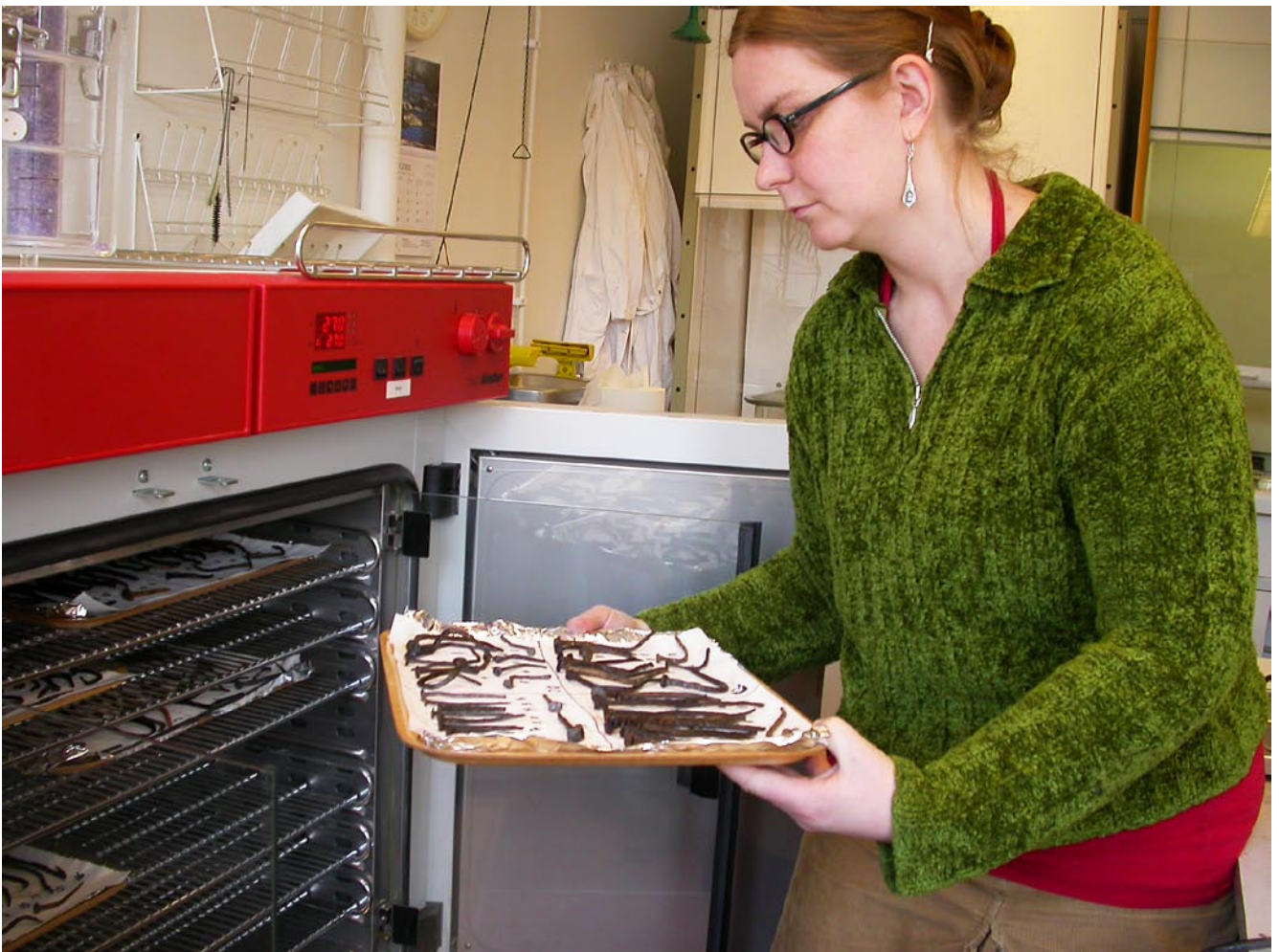
De med rostskyddsmedel preparerade spikarna läggs in i klimatskåpet för korrosionsprovning.
