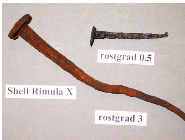
Exempel på spikar, efter korrosionsprovning, som rostskyddsbehandlats med Shell Rimula X.
