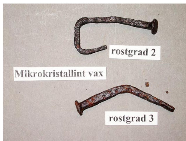
Exempel på spikar, efter korrosionsprovning, som behandlats med mikrokristallint vax.
