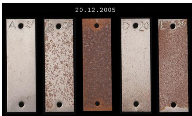
Obehandlad referens. Provkuponger före (övre raden) och efter (undre raden) test. Fotot visar endast ordinarie, dvs. ej det kompletterande testet.
