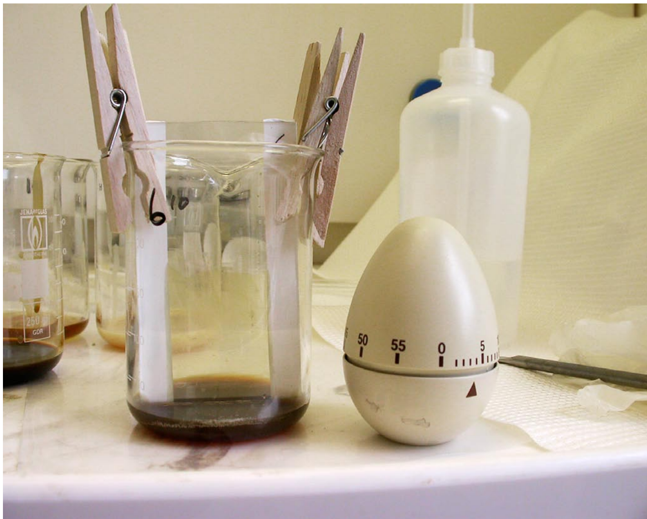
Test av rostskyddsmedlens uppsugningsförmåga mellan glasskivor.
