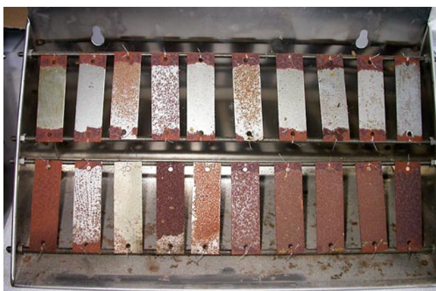
Provkuponger efter två års exponering i Landskrona.
