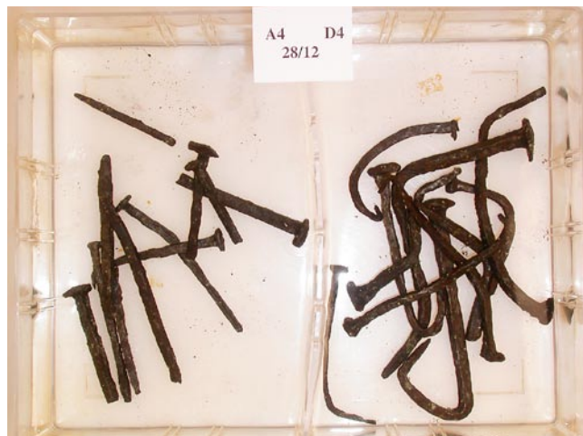
Spikar under urlakning i dinatriumvätefosfat i avjoniserat vatten.
