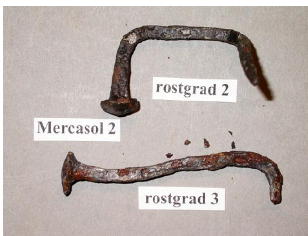
Exempel på spikar, efter korrosionsprovning, som rostskyddsbehandlats med Mercasol 2.
