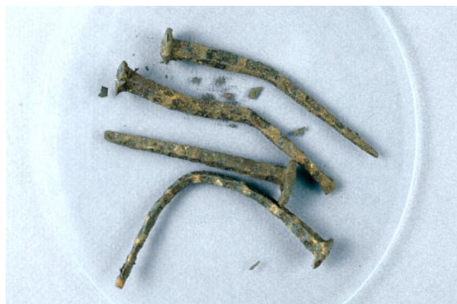
Spikar preparerade med Dinitrol 25 B efter test i klimatkammare av inte urlakat arkeologiskt järn.
