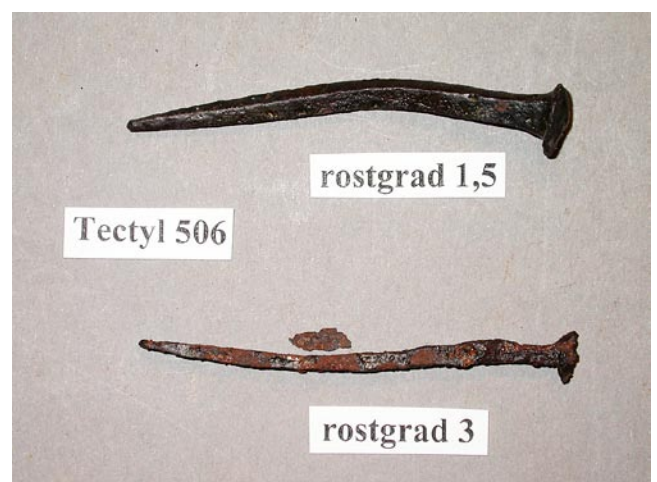
Exempel på spikar, efter korrosionsprovning, som rostskyddsbehandlats med Tectyl 506.
