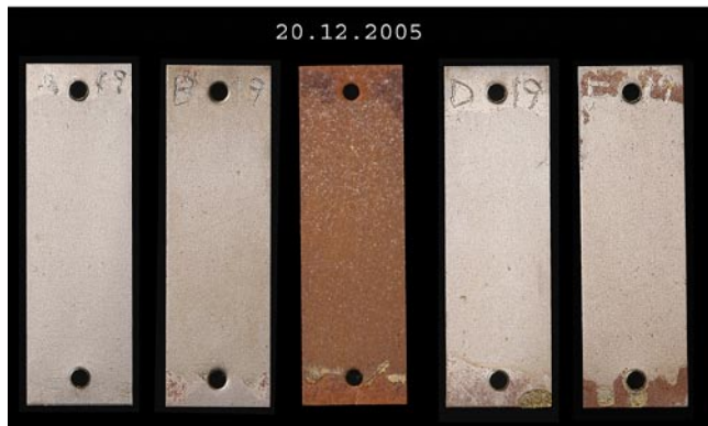
Rå linolja med balsamterpentin. Provkuponger före (övre raden) och efter (undre raden) test. Fotot visar endast ordinarie, dvs. ej det kompletterande testet.
