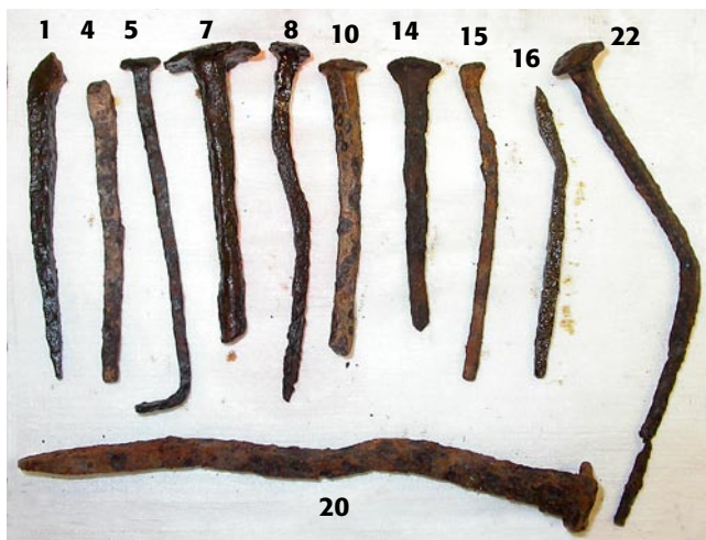
Spikar som urlakats i avjoniserat vatten med tillsats av natriumhydroxid, pH 12,5 efter korrosionsprovning i klimatkammare.
