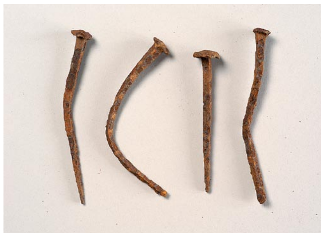
Spikar preparerade med Dinitrol 25B före test av inte urlakat arkeologiskt järn.
