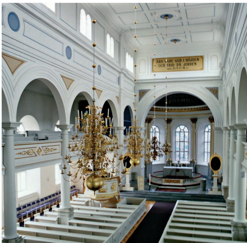
Fig. 138. Njurunda i Medelpad uppfördes 1856–62 efter ritningar av Johan Fredrik Åbom. Byggmästare var Johan Nordell. Det monumentala kyrkorummet avdelas i tre skepp genom kolonner som bär såväl sidoskeppens läktare som det förhöjda mittskeppet. Inredningen är i allt väsentligt från byggnadstiden. Vid en restaurering 1993 tog man fram äldre målad dekor och återställde den gamla altarringen. Foto Göran Lindahl 1998.
