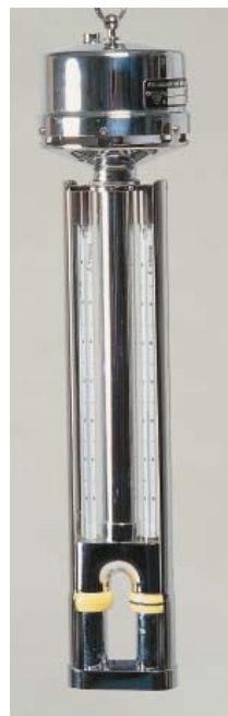
Assmannpsykrometer. Båda termometrarna är numererade och certifierade.
