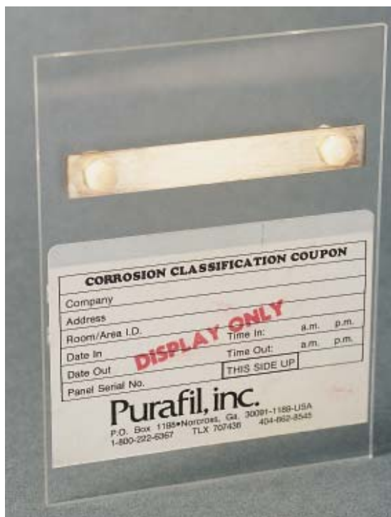
Silverkupong för mätning av korrosion.
