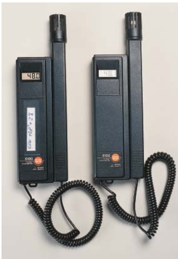
Elektroniska termohygrometrar för mätning av lufttemperatur och relativ luftfuktighet.
