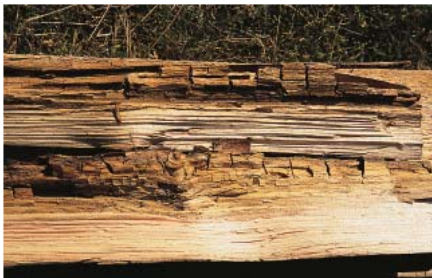
Angrepp av brunröta på en kluven stock. Angreppet är begränsat till de missfärgade bruna områdena, där veden under upptorkning har spruckit i karakteristiska kuber.
