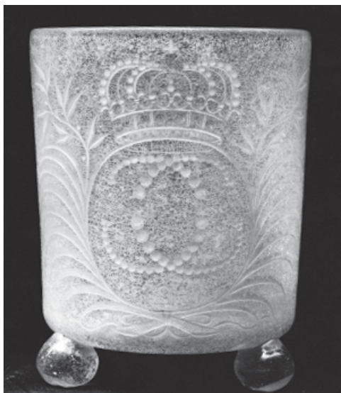
Glasbägare i framskridet stadium av glassjuka. Hela ytan är täckt av ett tätt nätverk av fina sprickor, glaset är mjölkaktigt och helt ogenomskinligt. Kungsholms glasbruk, 1600-talets slut. Nordiska museet, inv.nr. 126194.
