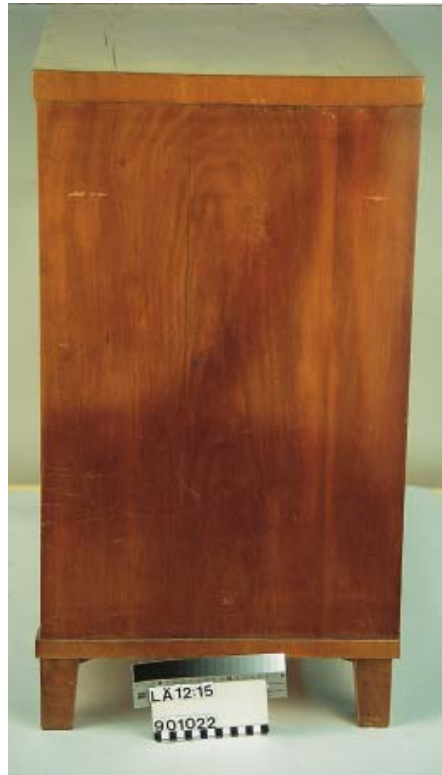
Dagsljus, ej direkt solljus, har blekt byråsidan. En stol har stått framför byrån i ca 40 år, och man kan se en mörkare skugga efter stolen.
