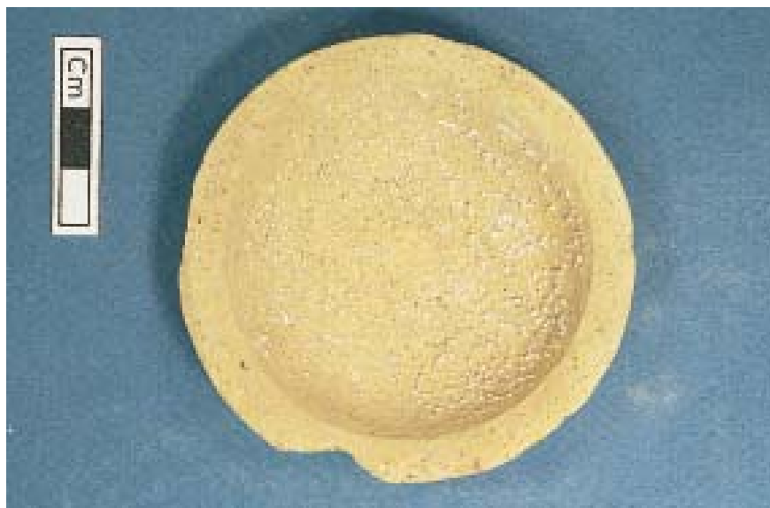
Saltkristaller i form av små vita prickar som fällts ut på ytan av en porös keramikskål från Cypern. Skålen har också fått en något mjölig, uppluckrad yta. Medelhavsmuseet.
