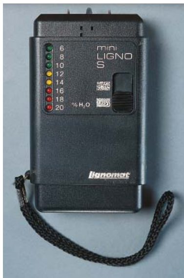
Elektrisk fuktkvotmätare. Stiften trycks in i en trähylla i museimagasinet, och fuktkvoten i de magasinerade organiska materialen kan avläsas.
