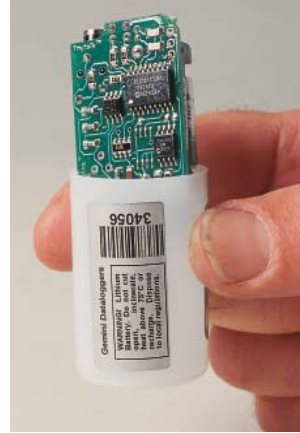
Datalogger som kan lagra tusentals mätvärden och mäta under ett helt år.
