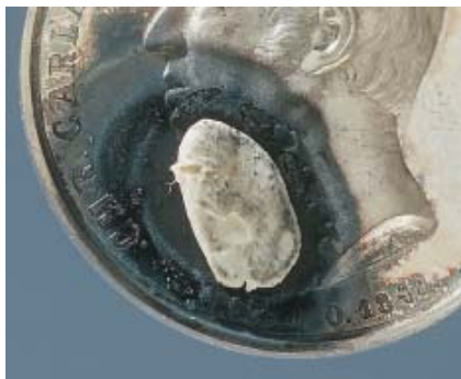
Silvermedalj skadad av svavel i plastelina. Tydliga gropfrätningar syns efter rengöring.
