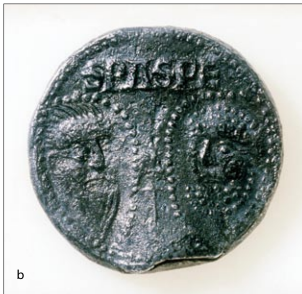
Figur 2. Blybulla skadad av luftburna organiska syror (a) och blybulla efter konservering (b). Foto: Gunnel Jansson, RAÄ.
