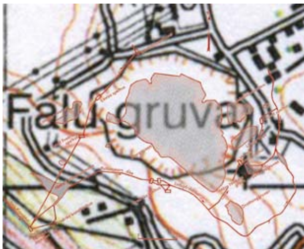
Det tekniska systemet. Vid 1700-talets slut leddes vattnet till en rad olika mekaniska anläggningar för att driva vattenhjul och spelhus som höll gruvan läns och transporterade arbetare, brutet berg och material. Detta var slutpunkten i ett ännu större tekniskt system, med hela raden av dammanläggningar, hålldammar och kanaler. Karta: Jan af Geijerstam. Topografisk karta med rektifierat överlägg av karta från Lindroth (1955) fig. 287, s. 641.
