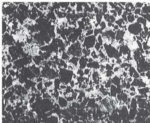
Foto 28. Slipprov (förstoring 10×) från putsilagning utförd omkring 1930. Kalmar slott, inre borggården, norra fasaden. Foto 1965, Puts- och murbrukslaboratoriet i Malmö.
