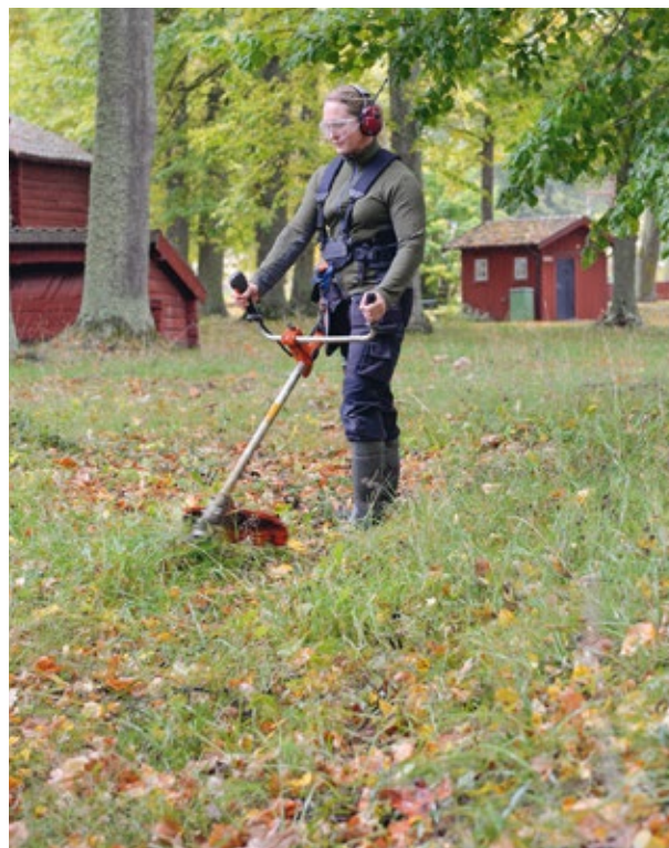
Röjsåg med sele och röstyre. Trimmertråd kan användas där gräset inte är så kraftigt. Julita gård, Södermanland. Foto: Klara Holmqvist.
