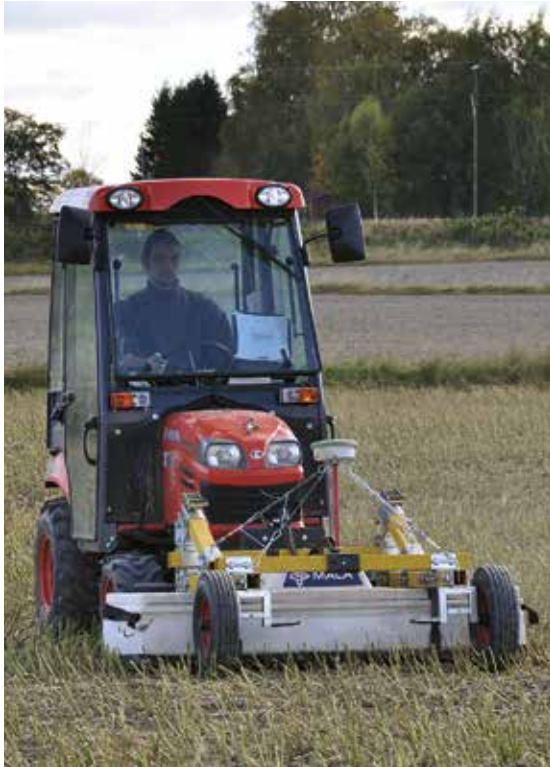
Motoriserad MALÅ Imaging Radar Array (MIRA). Georadarantennanordning är monterad i lådan framför traktorn. GPS-antennen för exakt positionering av mätdata syns monterad ovanpå MIRA antennlådan. Foto: Immo Trinks.
