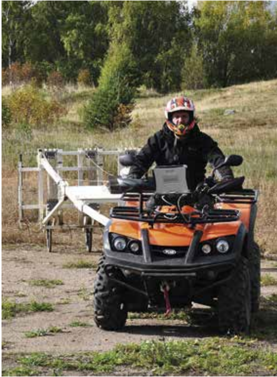
Magnetometersystemet i bruk på fältet öster om Högsengravfältet i Gamla Uppsala. Fem känsliga gradiometerinstrument som registrerar förändringar i jordens magnetfält är monterad på en omagnetisk vagn tillsammans med en GPS för positionering med centimeter noggrannhet. Foto: Immo Trinks.
