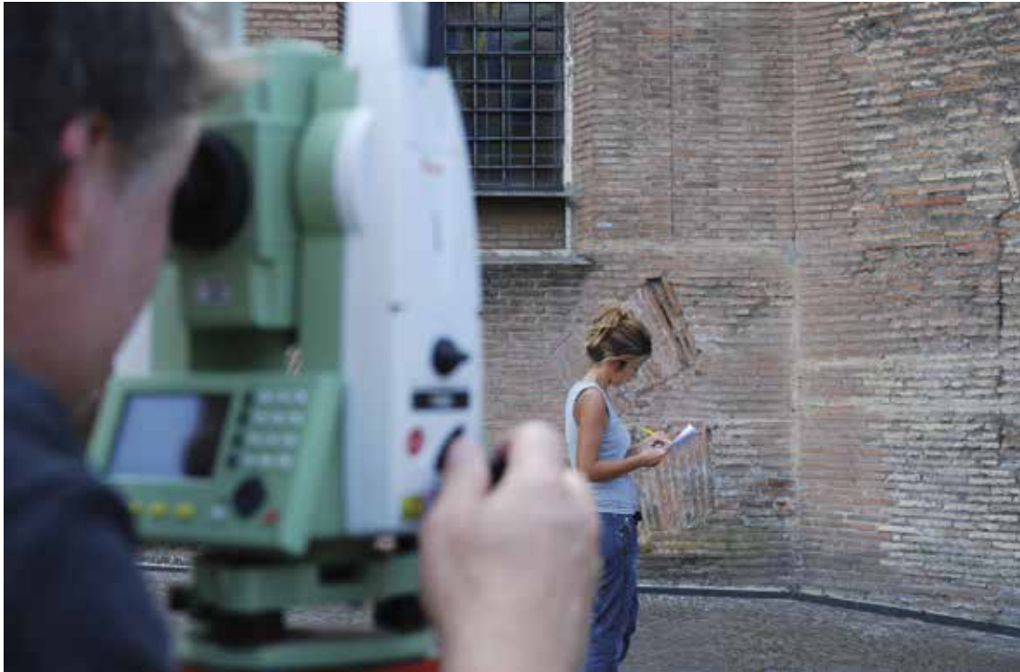
Markeringstejp med kryss på användes som markörer på fasaden. Markörer mättes sedan in med totalstation så att de olika fasaderna kunde sättas samman till en modell av hela baptisteriet. På bilden mäter Håkan Thorén (RAÄ-UV) in en av markörerna på sida E och Agostina Appeteccia (PIAC) antecknar. Foto: Hanna Menander.
