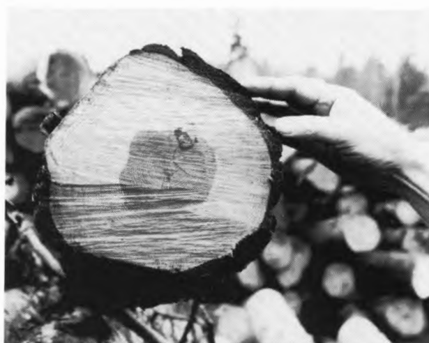
Virke av god kvalitet med hög andel kärnved användes för liggtimring. Det fick inte se ut som på bilden till höger, där större delen består av splintved. Foto Uno Söderberg.
