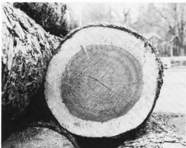
Virke av god kvalitet med hög andel kärnved användes för liggtimring. Det fick inte se ut som på bilden till höger, där större delen består av splintved. Foto Uno Söderberg.
