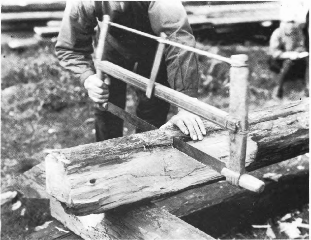
Sågen liksom yxan har varierat i utformning beroende på till vad den skall användas. Här en gammaldags ställningssåg. Foto i Nordiska Museets arkiv, Etnologiska undersökningar 1929.
