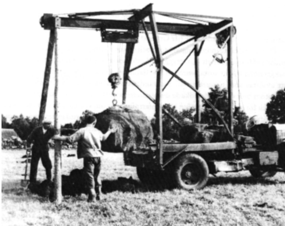
Under 1950-talet intensifierades ansträngningarna att skapa bärkraftiga jordbruksenheter. Lastbilar med stenröjningsaggregat blev effektiva redskap i arbetet med att förbättra odlingsmarkernas arrondering, men rationaliseringarna fick samtidigt till följd att många ålderdomliga odlingslandskap utplånades. Foto: Smålands museum.
