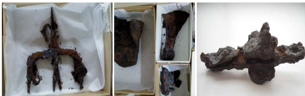
Bild 7, 8 och 9. Fynd som behandlats i samband med utgrävning. Korrosionen börjar inifrån och bildar stora sprickor som leder till att ytan lossnar som stora flagor eller bitar. Föremålen kan även skikta i flera lager och går sönder i flera delar.
