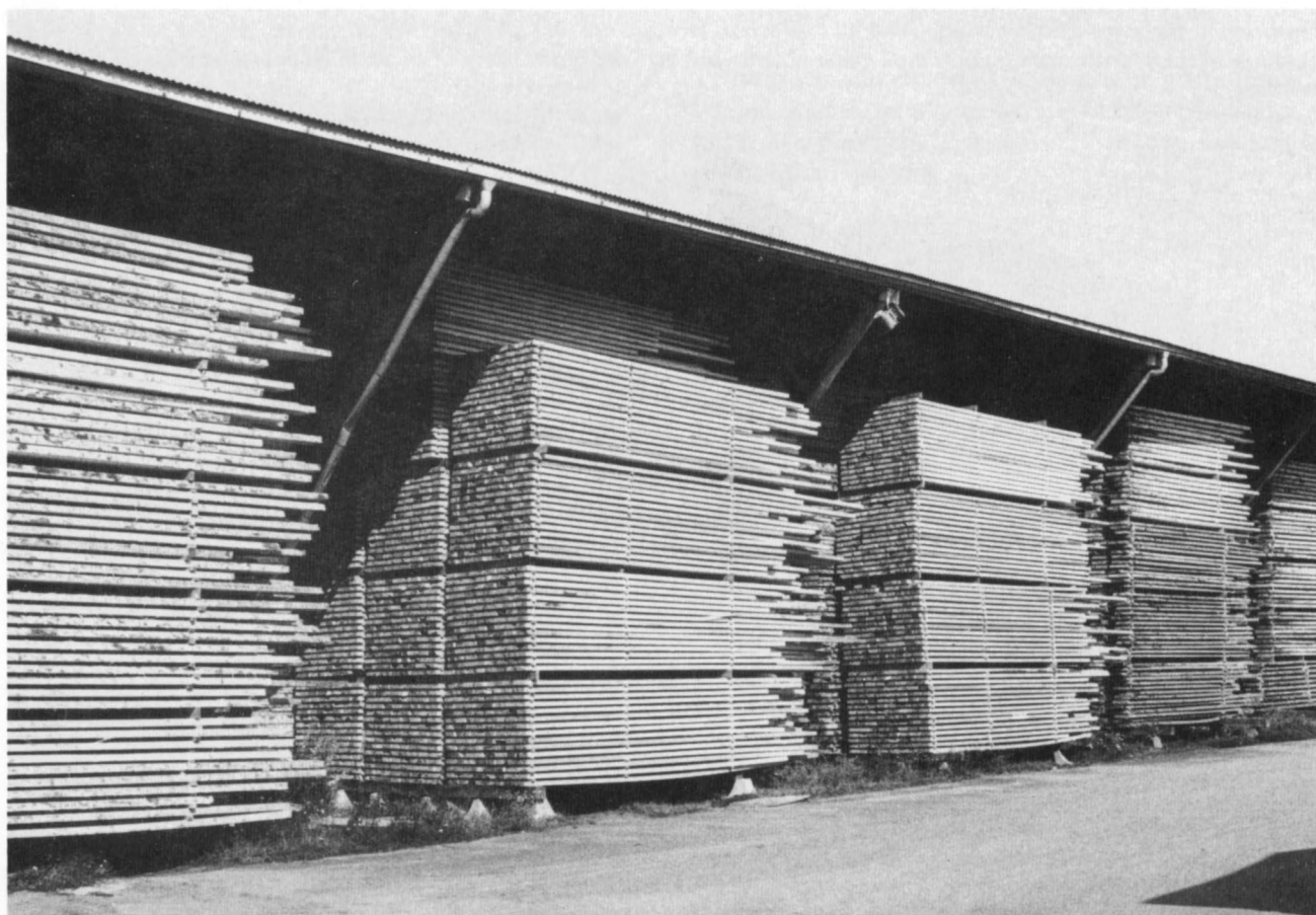
Efter sommarens torkperiod i brädgårdsstaplar sker en sortering varefter det felfria virket läggs för ytterligare torkning i förråd som ofta består av hus med gavlar och tak men utan en eller båda långsidorna. Foto: Uno Söderberg
