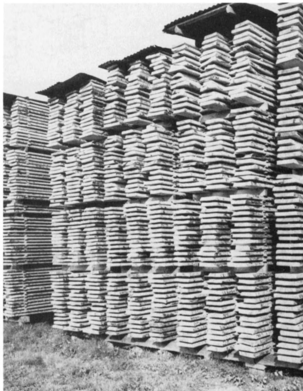
Förr omgavs sågverket av gårdar med stora brädstaplar där virket låg strölagt och takat. Metoden att lufttorka träet förekommer fortfarande, framför allt vid en del mindre verk som producerar högvärdigt virke av mogna rotstockar. Foto: Uno Söderberg, 1980
