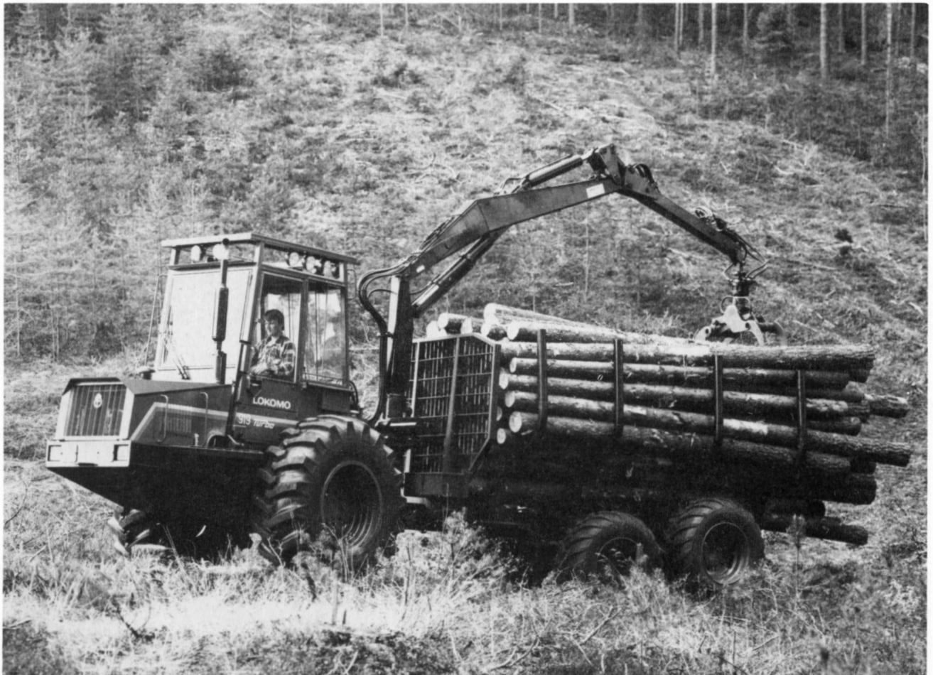
Hästen är ersatt av maskin med griplastare. Maskinen kan forcera svår terräng, åtminstone sommartid. Föraren sköter hanteringen helt och hållet från sin hytt, lastning, transport och lossning. På bilden syns skador på stockarnas mitt som är åstadkomna av lastapparaten. Foto: SIA
