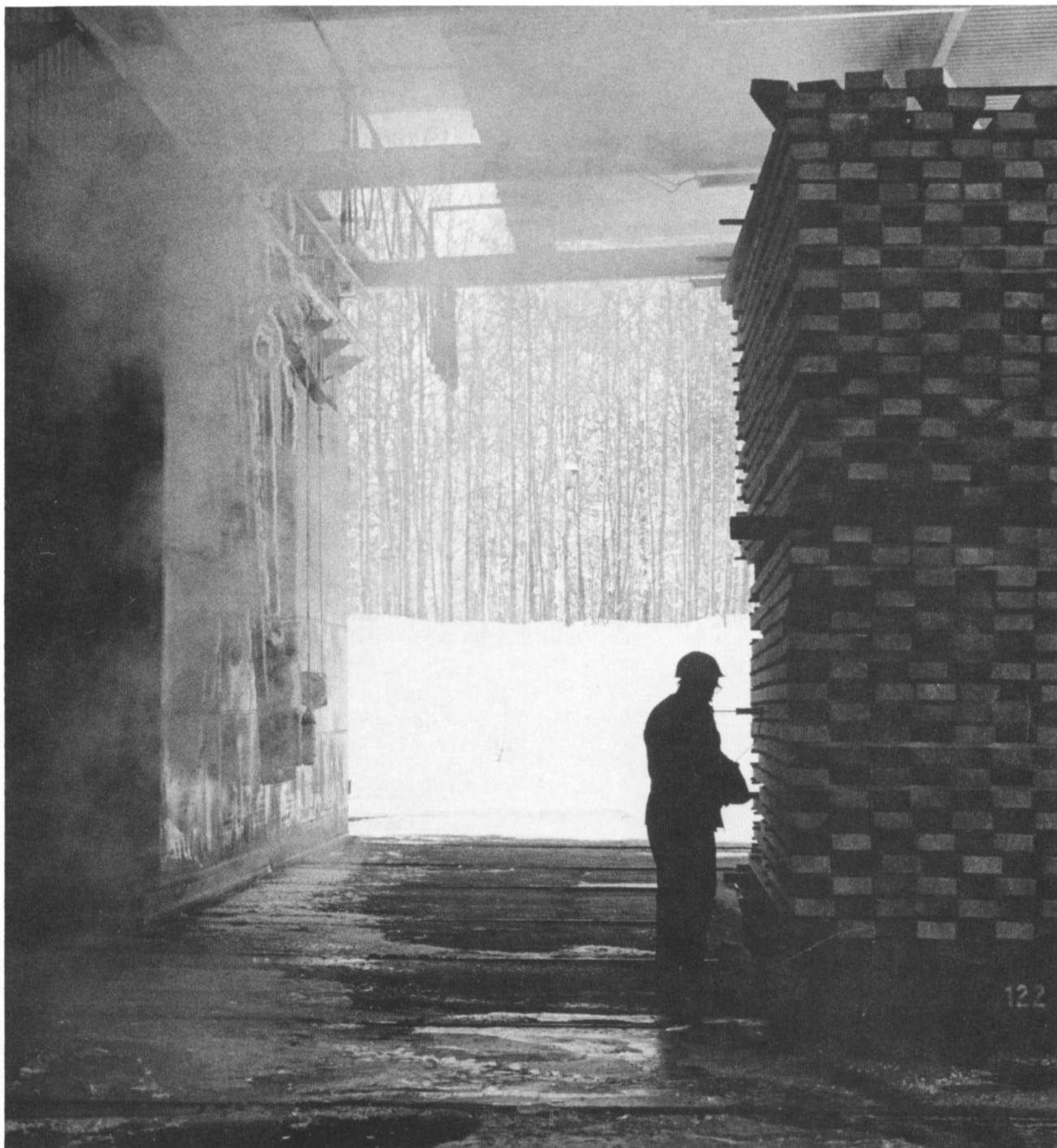
Virke som vattenlagrats måste omgående torkas när nedfuktningen upphör, d v s omedelbart efter sågningen. Detta sker i s k sågverkstorkar som alla verk med fuktiga timmerlager måste förfoga över. Det händer att mögelanlag, som den nedfuktade veden bär på, utvecklar sig i torkens varma och fuktiga miljö. Foto: Vibeke Mathiesen
