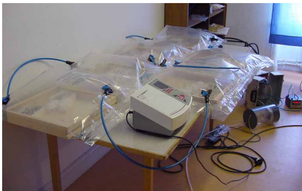
Försöksupställning för låg syrehaltsbehandling av insektslådor.
