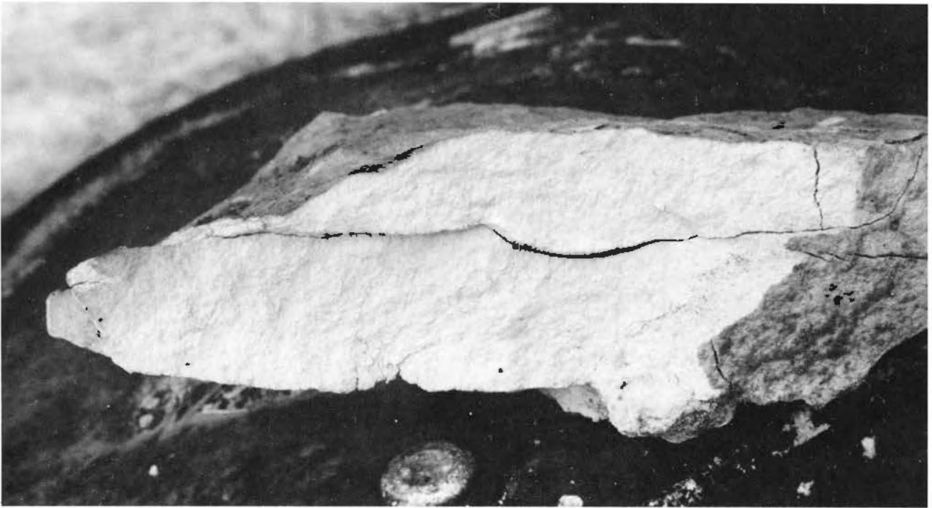
En genombränd kalksten har en vit, sockeraktig yta när den slås isär.
