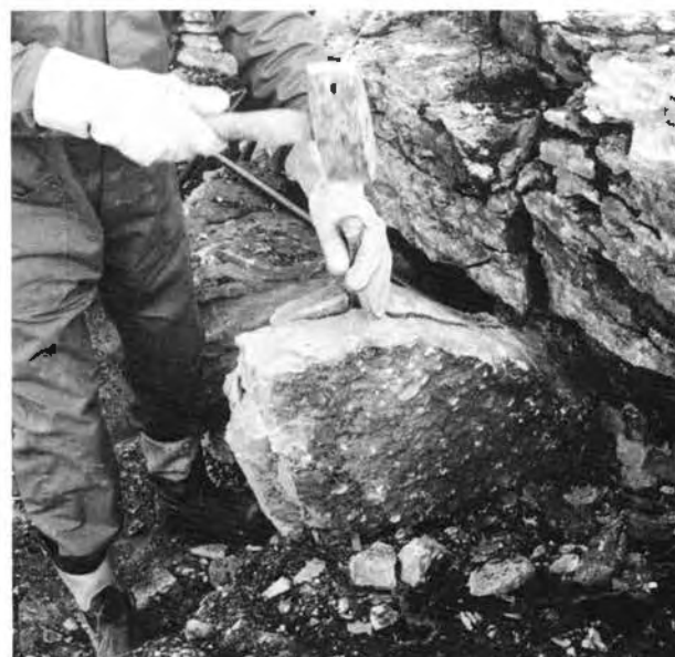
Efter en försiktig sprängning tas stora kalkstensblock fram med hjälp av spett. Blocken delas sedan upp i mindre bitar med slägga och kilar.
