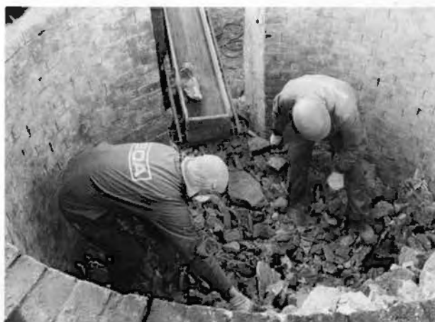
Stenen plockas ut för hand, och samtidigt sorteras dödbränd och obränd sten bort. Den dödbrända stenen känns igen genom att den är svart på ytan. Obränd sten går däremot inte att urskilja med blicken, utan det är tyngden som avslöjar den.
