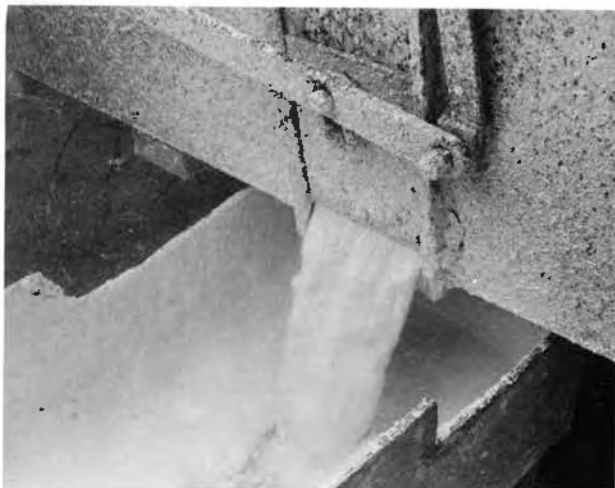
Den vällingliknande släckta kalken tappas via en lucka på plåtkarets sida.
