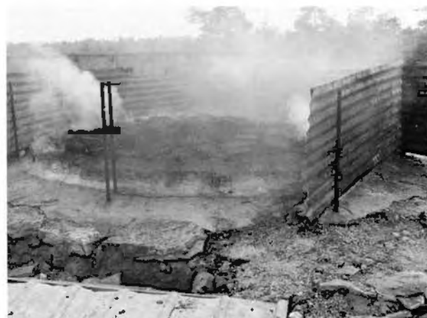
När röken avtar och det syns små blå lågor, som verkar hoppa uppe på toppen av ugnssatsen, då börjar bränningen vara färdig.
