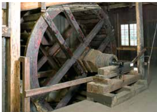
Hela den tekniska utrustningen finns bevarad med färskningshårdar och vattendrivna hamrar. Foto: Bengt A Lundberg/Raä.
