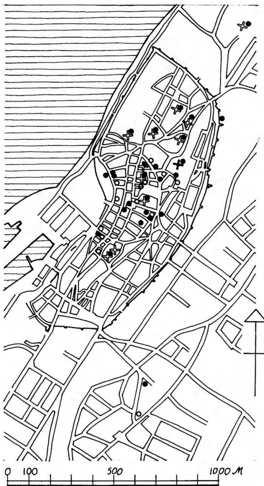
Figur 14. Visby. Byggnader med exteriört exponerad och bearbetad natursten markerade med cirklar. Fyllda cirklar avser byggnader med akuta skador.
