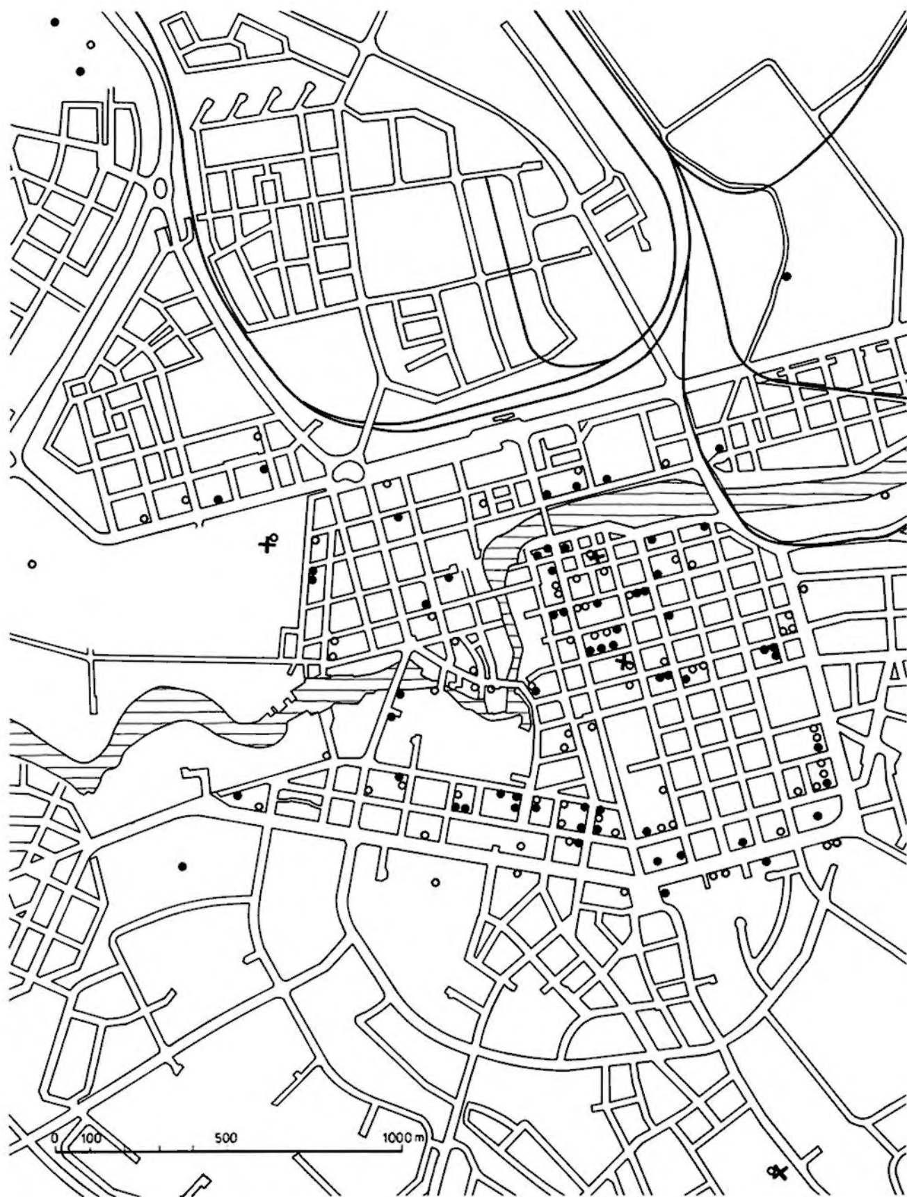
Figur 11. Norrköping. Byggnader med exteriört exponerad och bearbetad natursten markerade med cirklar. Fyllda cirklar avser byggnader med akuta skador.
