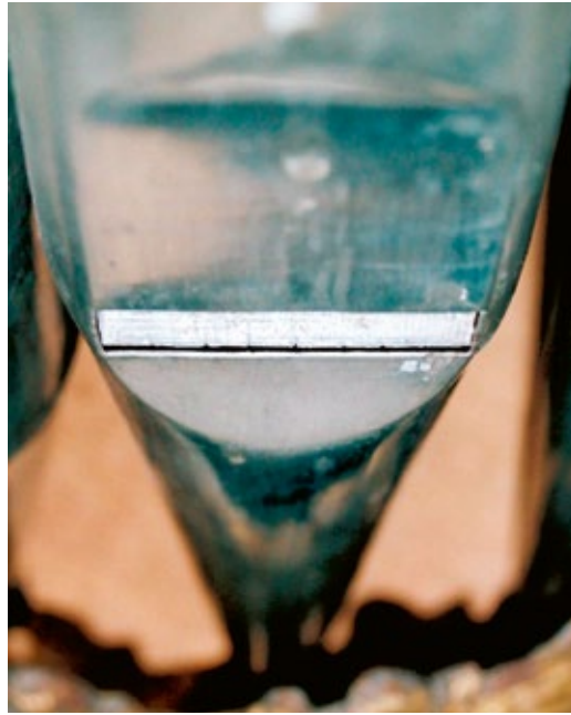
Fig. 21. Leufsta bruk. En av de största piporna i Principal 4' i ryggspositivet är ett representativt exempel på hur fasadprincipaler och flera av stämmorna i innerverket blivit bearbetade; delar av kärnstick som varit i princip liksidiga, djupt stuckna syns efter bearbetning med skrapning av kärnfasen och därefter efterjustering av underlabiet som pressats inåt. Det framgår av inbuktningarna i kärnspaltens ytterkanter, invid "mungiporna" på pipan och vid jämförelse med i intakt skick bevarade pipor där kärnans och underlabiets kanter är parallella hela vägen som i fasadprincipalerna i Linköping domkyrka för att nämna ett exempel.
