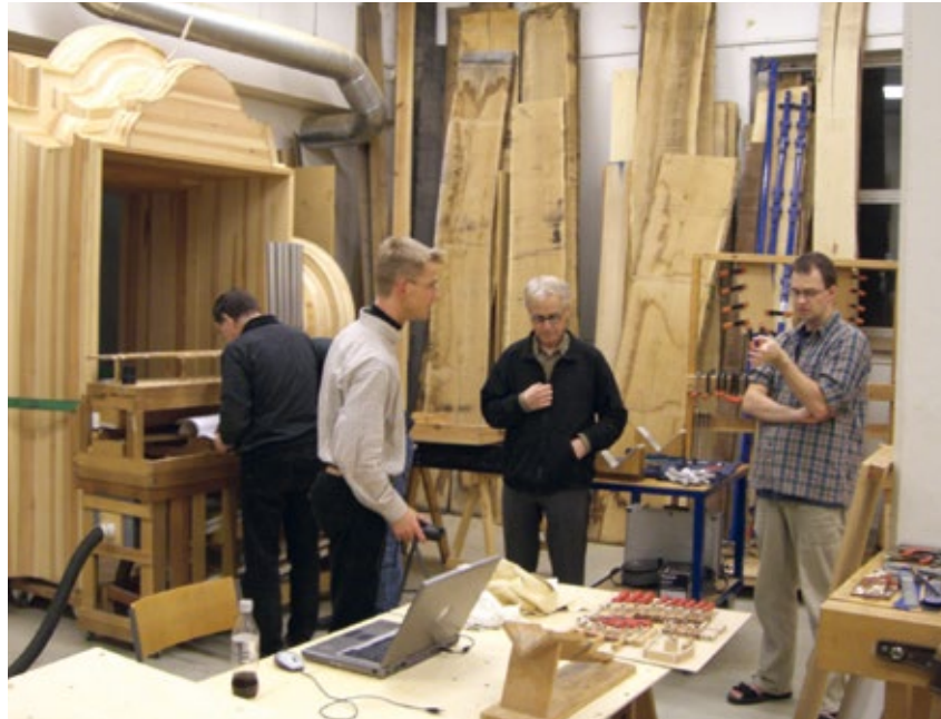
Fig. 27. Experiment med att restaurera kärnstuckna pipor, här i GOArt:s orgelverkstad, Göteborgs universitet. Vid intonationsorgeln till vänster står Mats Arvidsson, vid bordet med Bröderna Mobergs specialverktyg för minimering eller eliminering av kärnstick språkar Niclas Fredriksson, Axel Unnerbäck och Matthias Scholz.
