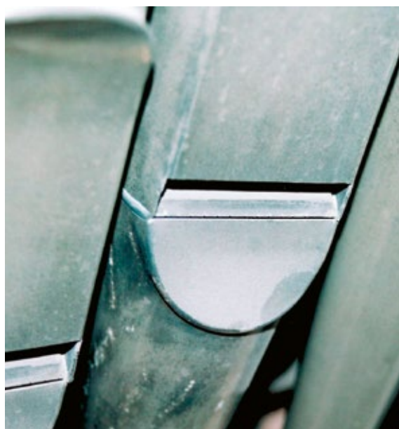
Fig. 30. Fasadpipor i bröstverkets Principal 4' i Dresden Katolische Hofkirche, en orgel påbörjad av G. Silbermann 1750, fullbordad av Z. Hildebrandt 1755. I samband med restaurering på 1960-talet minimerades kärnstick genom ifyllnad med en, enligt uppgift, massa av epoxyharts och eventuellt, som det av okulärbesiktning att döma ser ut, även med viss mekanisk igenpressning. Jämför den mer intakta situationen i Freiberg Dom, fig. 26 (s. 66).
