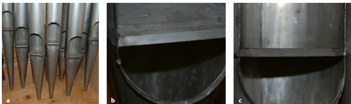
Fig. 5: a–c. Ramnäs, P. Z. Strand 1833. (a.) Fasadpipor vars ilödda labrier lossat när lödfogarna smält av värmen vid en brand i kyrkan i slutet av 2006. (b.) Igenpressade kärnstick av den typ Strand och Andersson introducerade på 1820-talet. (c.) Kärnstick vilka säkerligen under 1900-talet eliminerats genom att kärnans framkant blivit fasad och filad.
