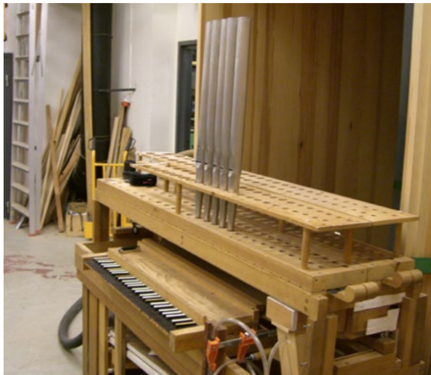
Fig. 28. Fem av de försökspipor som användes, placerade på intonationsorgeln. Vid försöken användes dock konsekvent endast två kancellar.
