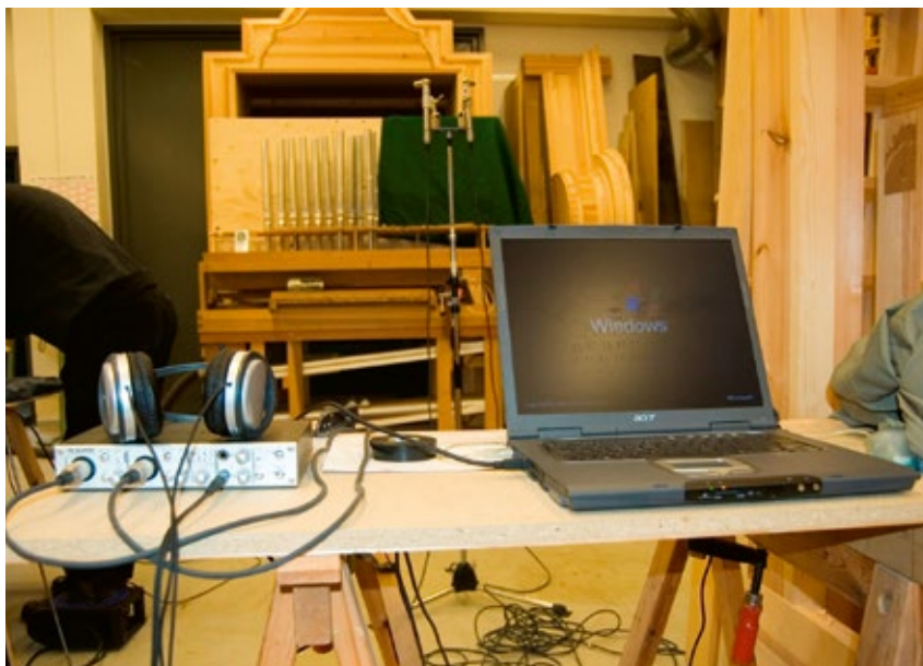
Fig. 29. Den successivt förändrade klangen i försökspiporna dokumenterades med hjälp av mikrofoner monterade på stativ en bit framför intonationsorgeln.
