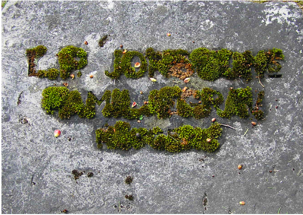
Näring och fukt befrämjar biologisk påväxt. Ofta ser man att det börjar växa först i stenyttans fördjupningar. Foto: Helen Simonsson, RAÄ
