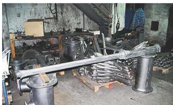
Nyttillverkning av lyktstolpar till Skeppsholmsbron i Stockholm. Överst ena halvan av gjutformen. Därunder en färdiggjuten stolpe. Foto: MTö
