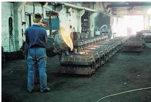
Interiörbild från Mölltorps gjuteri. Gjutning av gråjärnsdetaljer. Foto: MTö
