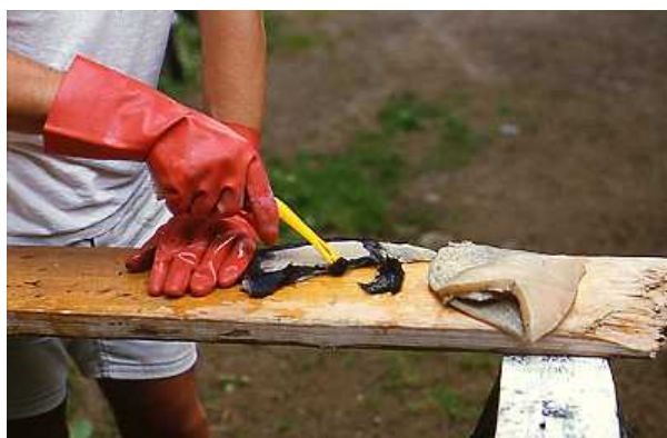
Limgods till hudlim. Hantverksmässig avhåring efter slutförd kalkbehandling. Foto: BSk
