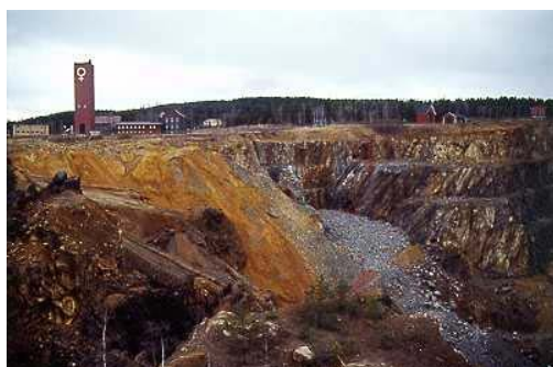
Vid dagbrottet i Stora Kopparberg i Falun vittrar slaggen långsamt ner till ett utmärkt pigment för röd slamfärg. Foto: KKLy
