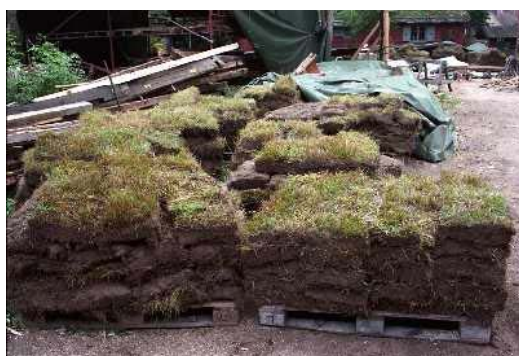
Färdigkapade torvstycken, klara att läggas på tak. Foto: Kulturen i Lund
