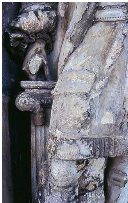
Nationalmuseum Stockholm. Bilden visar Tessin- skulpturens högra ben och arm. Skulpturen är huggen i Carraramarmor och vittrar (sockrar) kraftigt. Det innebär att de enskilda kalcitkristallerna har förlorat vidhäftningen till varandra och att stenen sockrar vid beröring. Foto: Jan-Eve Olsson
