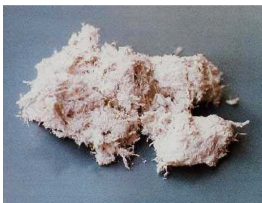
Ett stycke upparbetad krysotil.
