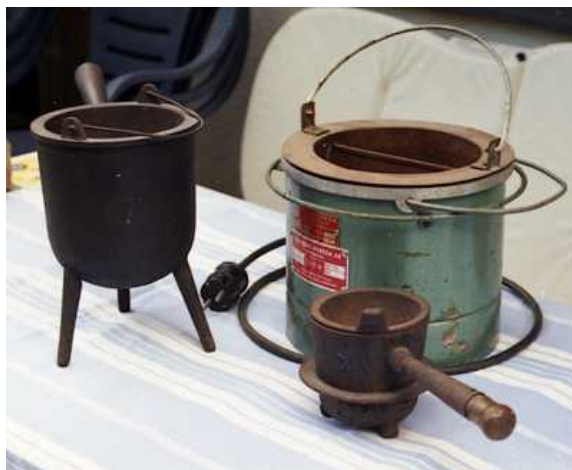
Olika typer av limpottor (dubbelkokare) för glutinlim. Två är avsedda för öppen eld och en för elektricitet. Foto: BSk
