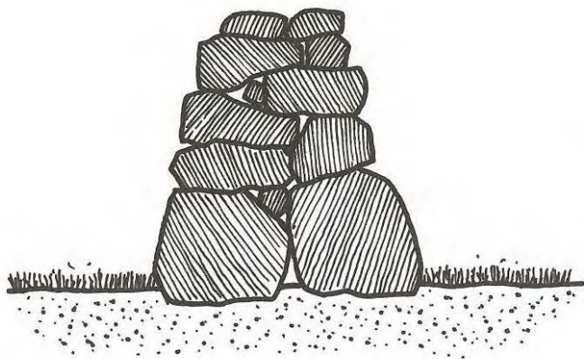
Enkelmur. Stenarna har lagts på varandra utan några egentliga konstruktionsdetaljer.
