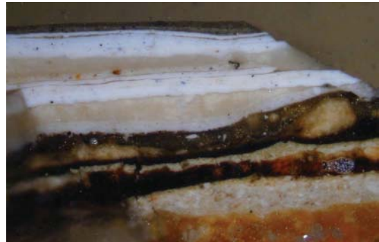
Snitt från Västra trappans gröna marmorering, fotad på RAÄs konserveringsavd. Foto: K. Calissendorff
