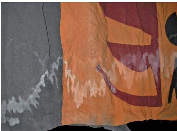
En ridå skapad för Vår Teater på 1950-talet av konstnären Randi Fisher. Man kan tro att de vita märkena beror på vattenskada, men det är troligtvis tecken på saltvandring orsakad av flamskyddsbehandling. Foto: HV Ateljé.
