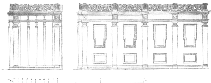
Fig. 20. Danderyd. Skärm kring värmeledningsöppningar i norra skeppet. Efter ritning av prof. L. I. Wahlman. Schrank um die Öffnungen der Zentralheizungskanäle (1915).
