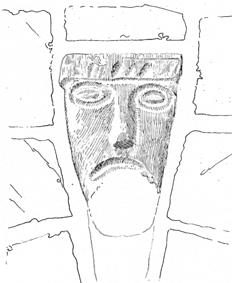
Fig. 181. Modellerad slutsten av tegel i omfattningsbågen över det östra fönstret fig. 180. Uppm. T. Sellman 1912.
