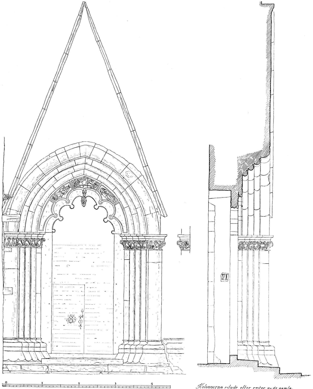
Fig. 35. Långhusets sydportal, fasad och snitt. Skala 1:60. Südportal des Langhauses, Fassade und Querschnitt.
