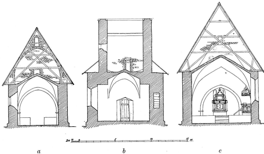
Fig. 260. Tvärsektion: a. av koret mot väster; b. av tornet mot väster; c. av långhuset mot öster. Skala 1:300. Querschnitt: a. des Chores gegen W.; b. des Turmes gegen W.; c. des Langhauses gegen O.
