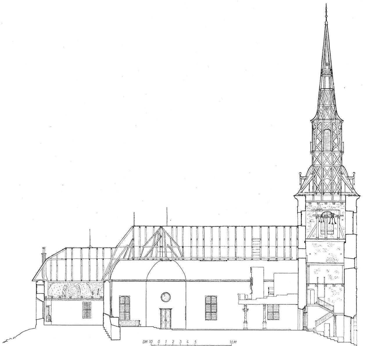
Fig. 231. Längdsektion. Skala 1 : 300. Längsschnitt. Longitudinal section.
