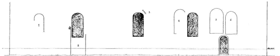
Fig. 14. Äldre byggnadsdetaljer, blottade vid yttre restaureringen 1951. S-muren. Uppm. E. Bohrn 1951, ATA. Old details of building, revealed during external restoration in 1951. S wall.
