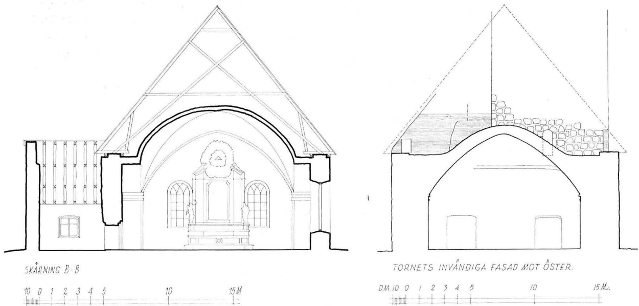
Fig 192–93. Tvärsnitt mot öster och väster. Spår efter västläktare samt högt belägen dörröppning i tornets östmur. 1:300. Uppm J Söderberg 1955, kompletterad 1967.
