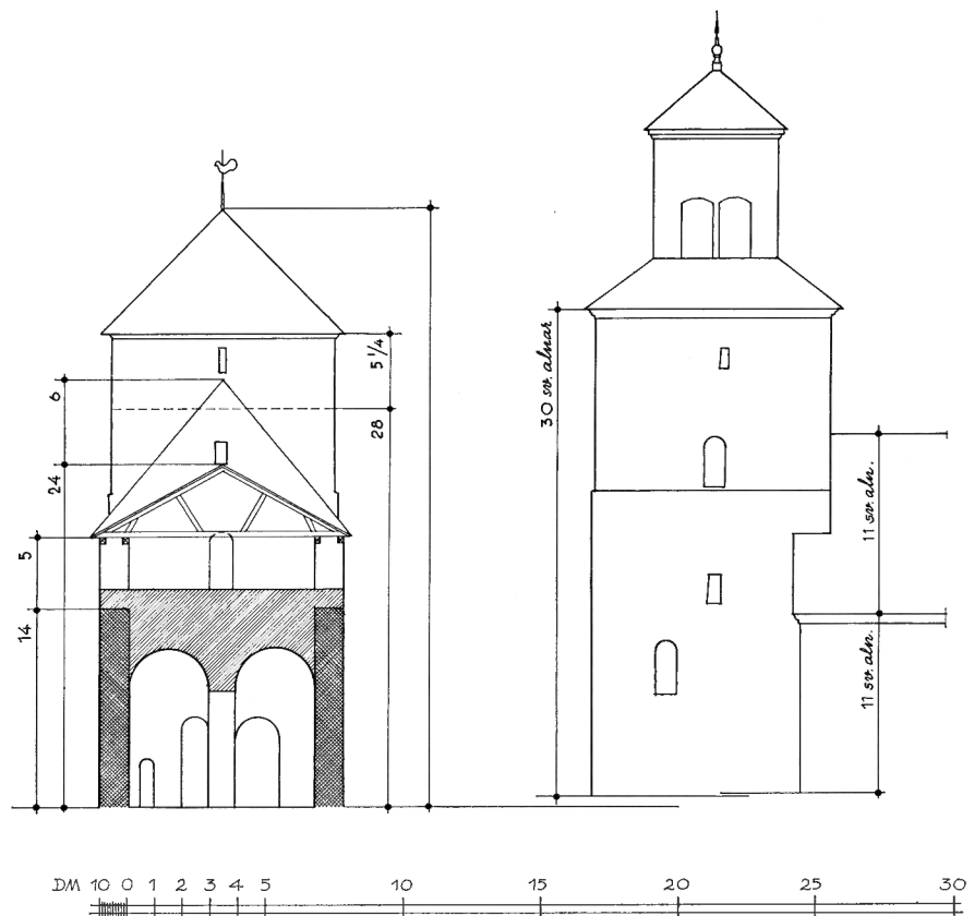
Fig. 408. Höjdmått i Löt kyrka, skala 1: 300. Metrologisk tolkning av S Göransson, ritad av J Söderberg 1975. T v sektion genom långhuset mot väster. Rekonstruktion av höjder i medeltidskyrkan. Mått i alnar om 52,0 cm. T h del av sydfasaden. Mått i tornet (1797) och långhuset (1840–1842) i svenska alnar à 59,38 cm.
