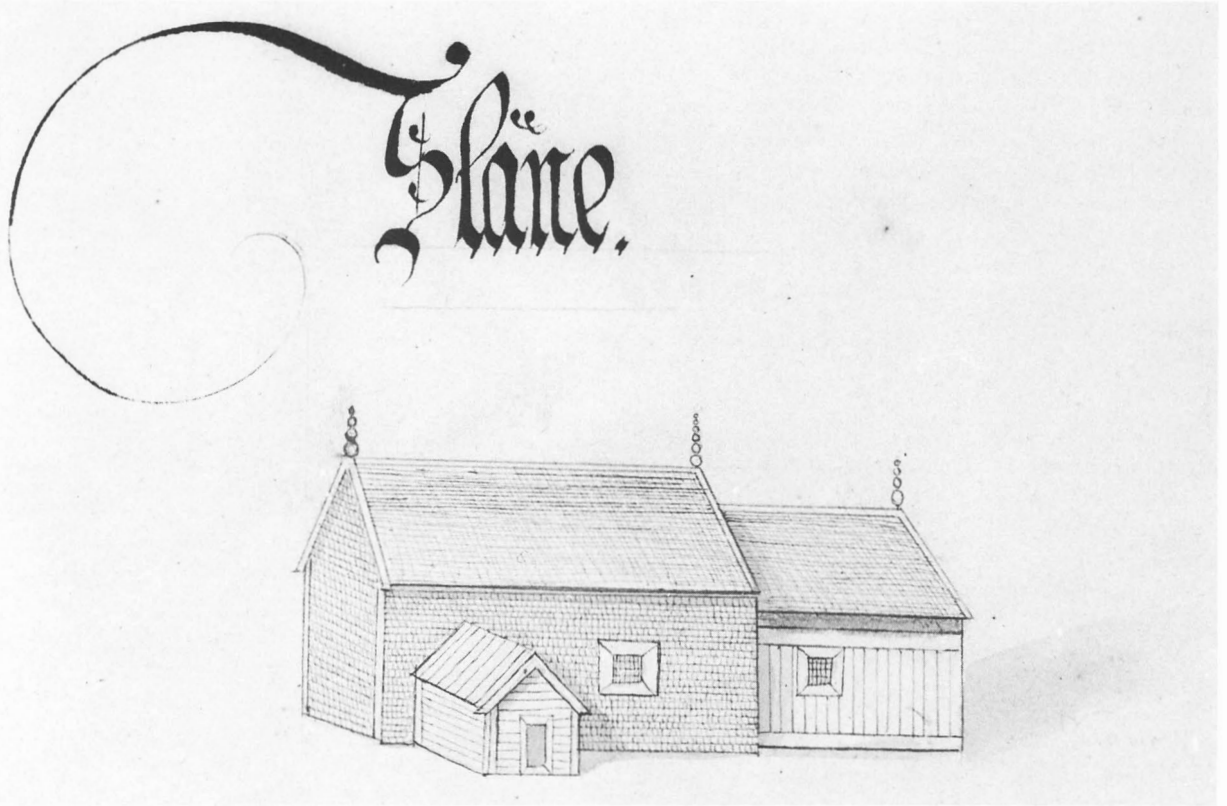
Fig 139. Slädene gamla kyrka med kor byggt av stående väggplankor. Riven på 1830-talet. Efter teckning i Peringskiöld IX. KB.
