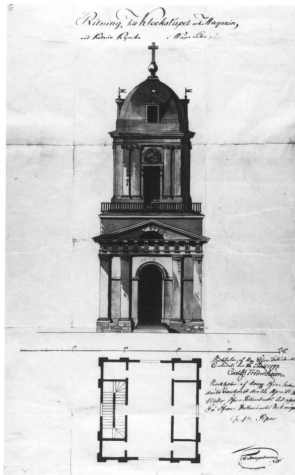
Fig 255. Kelviå klockstapel. Plan och fasad, förslag av O Tempelman 1799. RA.
