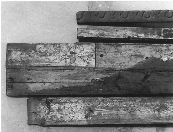
Fig. 159. Målade furubräder, troligen delar av det 1839 rivna korskranket. Funna under kyrkans golv. Foto E. Gustafsson 1956. ATA. Painted pine boards, probably from the rood-screen, removed in 1839.
